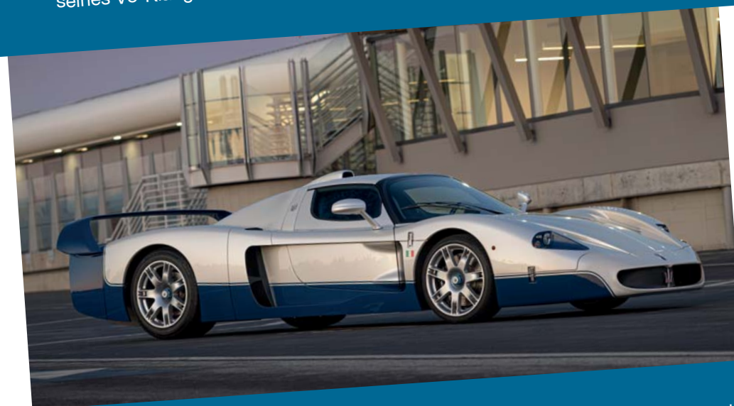
Maserati MC12 – Motor auf Basis Ferrari Enzo V12 632 PS, 1.335 kg
